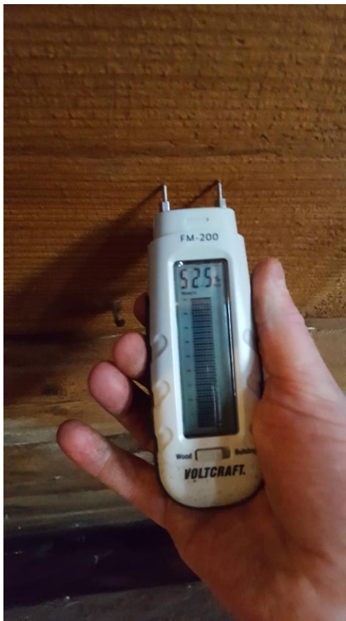
Č.53 – poškození vlhkostí obsaženou v dřevní hmotě, vlhkost 52,5 %
