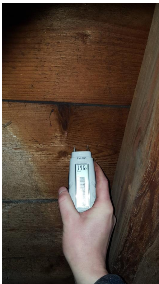
Č.17 – poškození zatékáním srážkových vod, vlhkostí obsaženou v dřevní hmotě, vlhkost 39,6%
